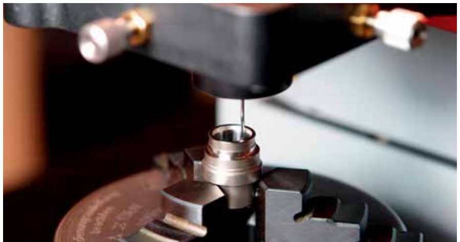
Bild 1. Die Rauheit einer innen gehohnten Oberfläche wird faseroptisch gemessen. Der Innendurchmesser des Bauteils beträgt 8 mm, der Sondenaußendurchmesser 0,8 mm.
