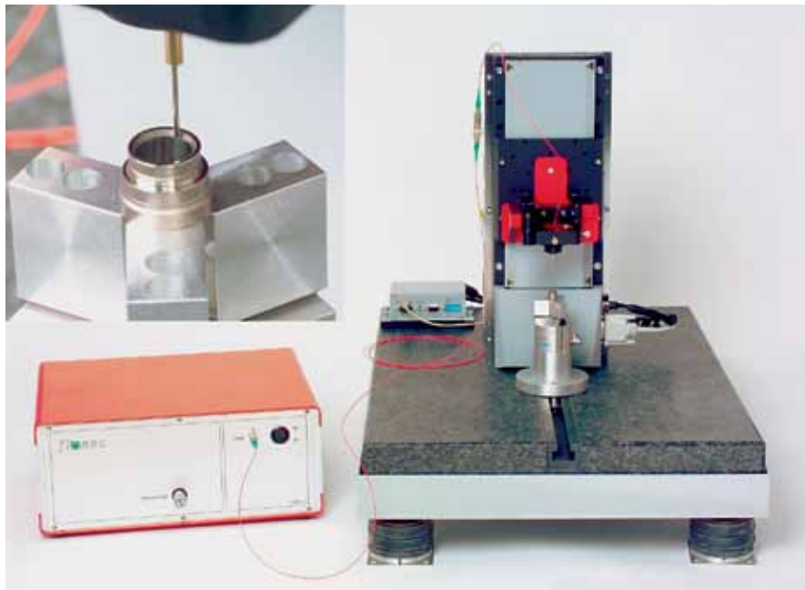
Bild 2. System zur optischen Rauheitsmessung in der Fertigung, links oben: faseroptische Messsonde in innengehohler Bohrung
